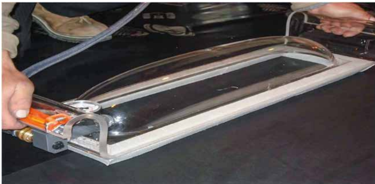
Контроль сварки с помощью вакуумного испытательного устройства
