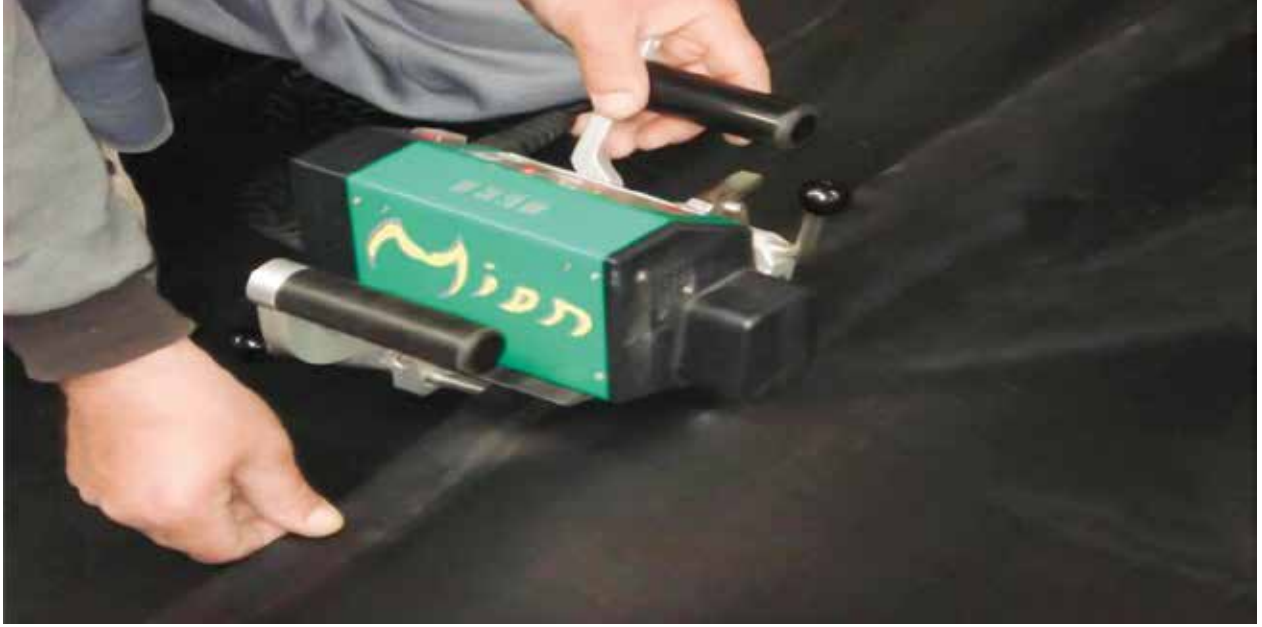
Otomatik kaynak robotu ile kaynak yapılması
