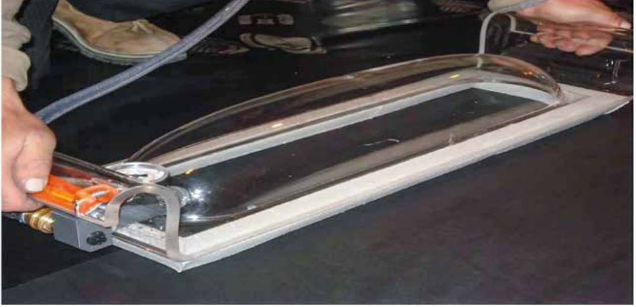
Vakumlu test cihazı ile kaynak kontrol
